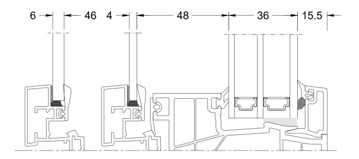
Flügelverglasung 28 mm Sash glazing 28 mm
