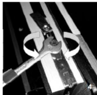
4. Anpressdruckverstellung an den Verriegelungen.
